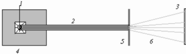
Рис. 3.5. Схема опыта Резерфорда по рассеянию альфа-частиц: 1 — радий, 2 — поток \alpha -частиц, 3 — экран, 4 — свинцовая защита, 5 — золотая фольга
